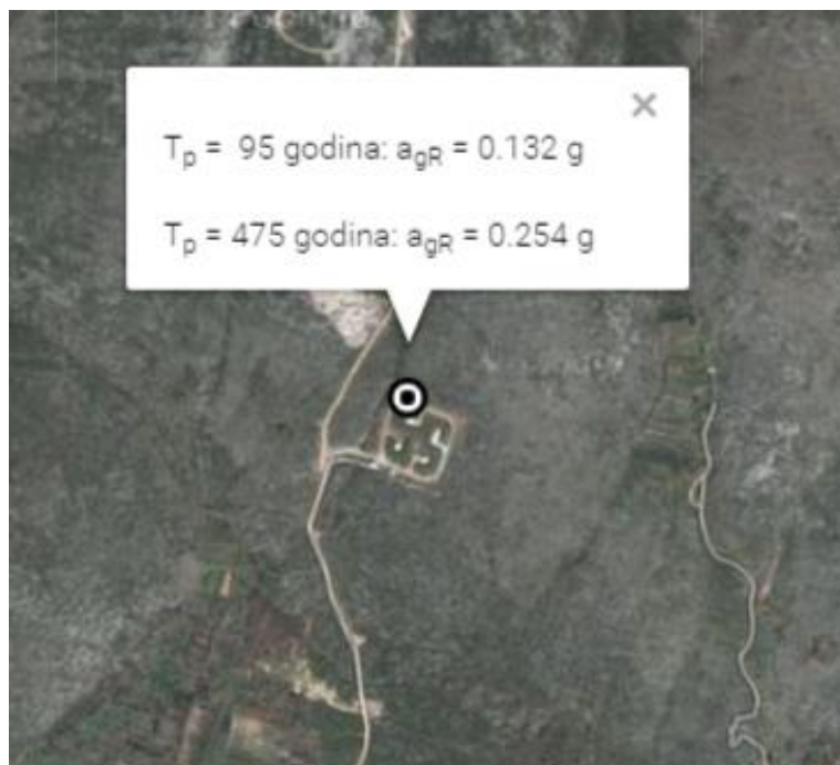
Slika 15. Iznosi vršnih ubrzanja tla za povratna razdoblja 95 i 475 godina za lokaciju Skladišta gospodarskog eksploziva Sičane
