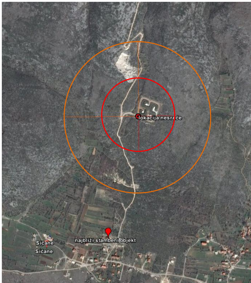
Slika 32. Zone utjecaja uslijed eksplozije prilikom prijevoza eksplozivnih tvari na lokaciji Skladišta gospodarskog eksploziva Sićane
